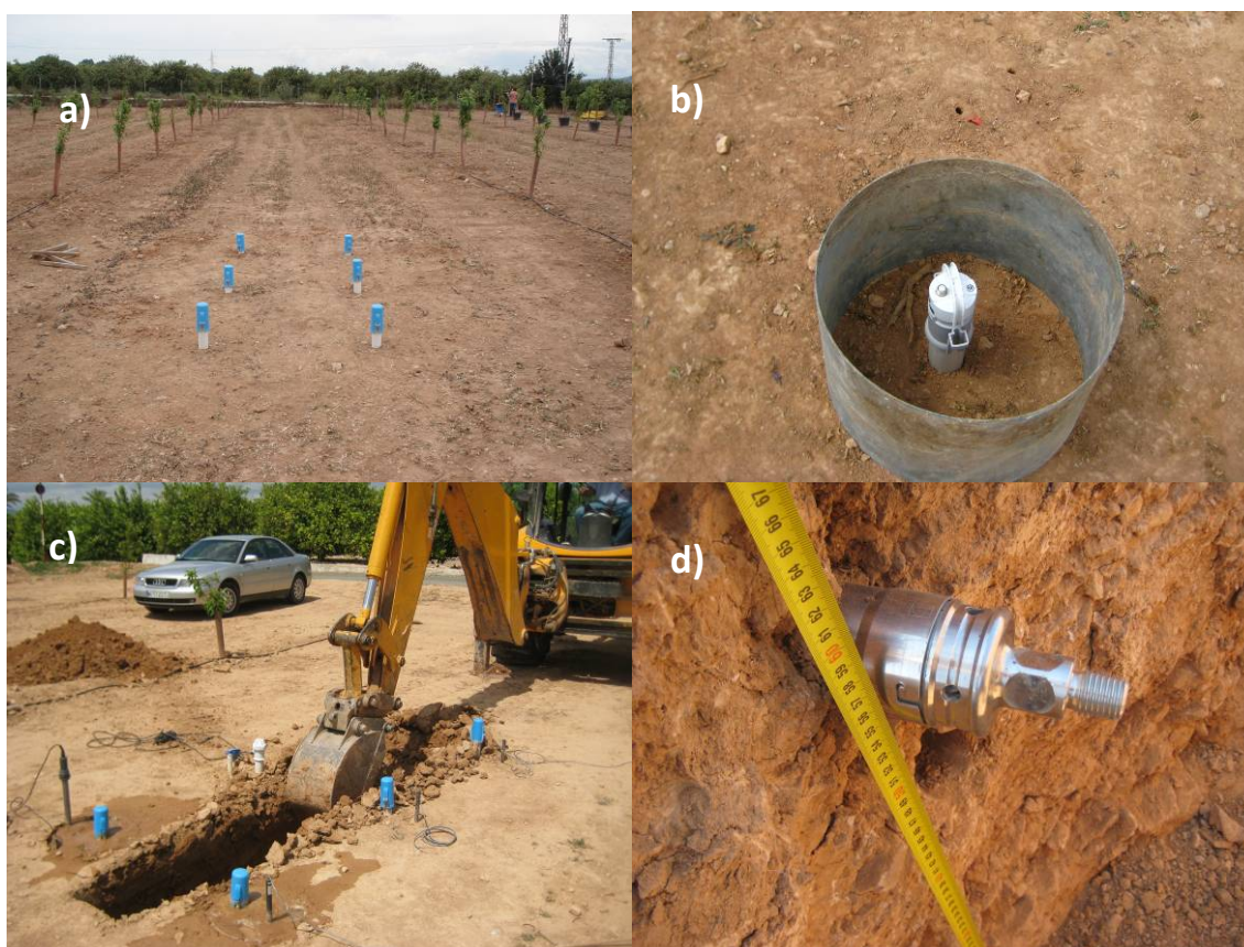
Figura 1. a) Tubos de acceso, b) Cilindro para saturar el suelo, c) Zanja y d) Muestreo de suelo.
